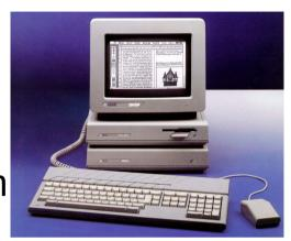
TT030 using pure 32bit 68030 CPU
